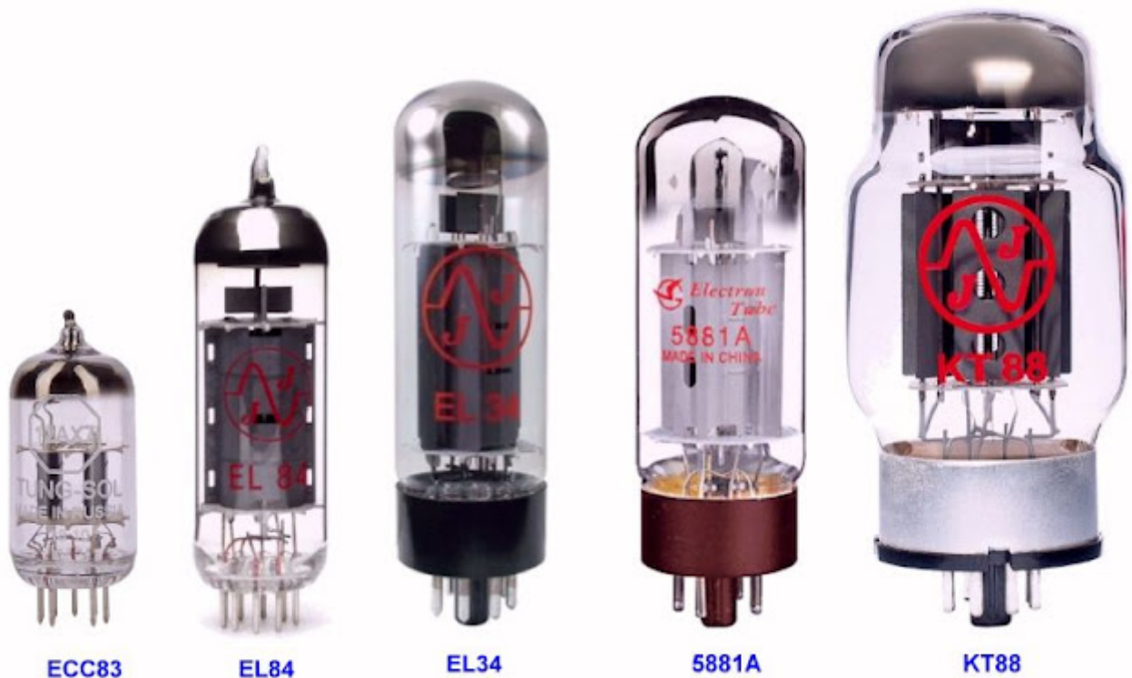
Het uiterlijk van nog vaak toegepaste buizen in audio-versterkers. (© 2021 Jos Verstraten)
