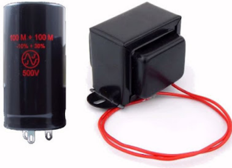
De speciale elco en smoorspoel die u in een buizen voeding nodig hebt. (© 2021 Jos Verstraten)
