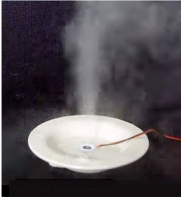
Een waternevel producerende piëzo-ceramische transducer. (© 2024 Jos Verstraten)
